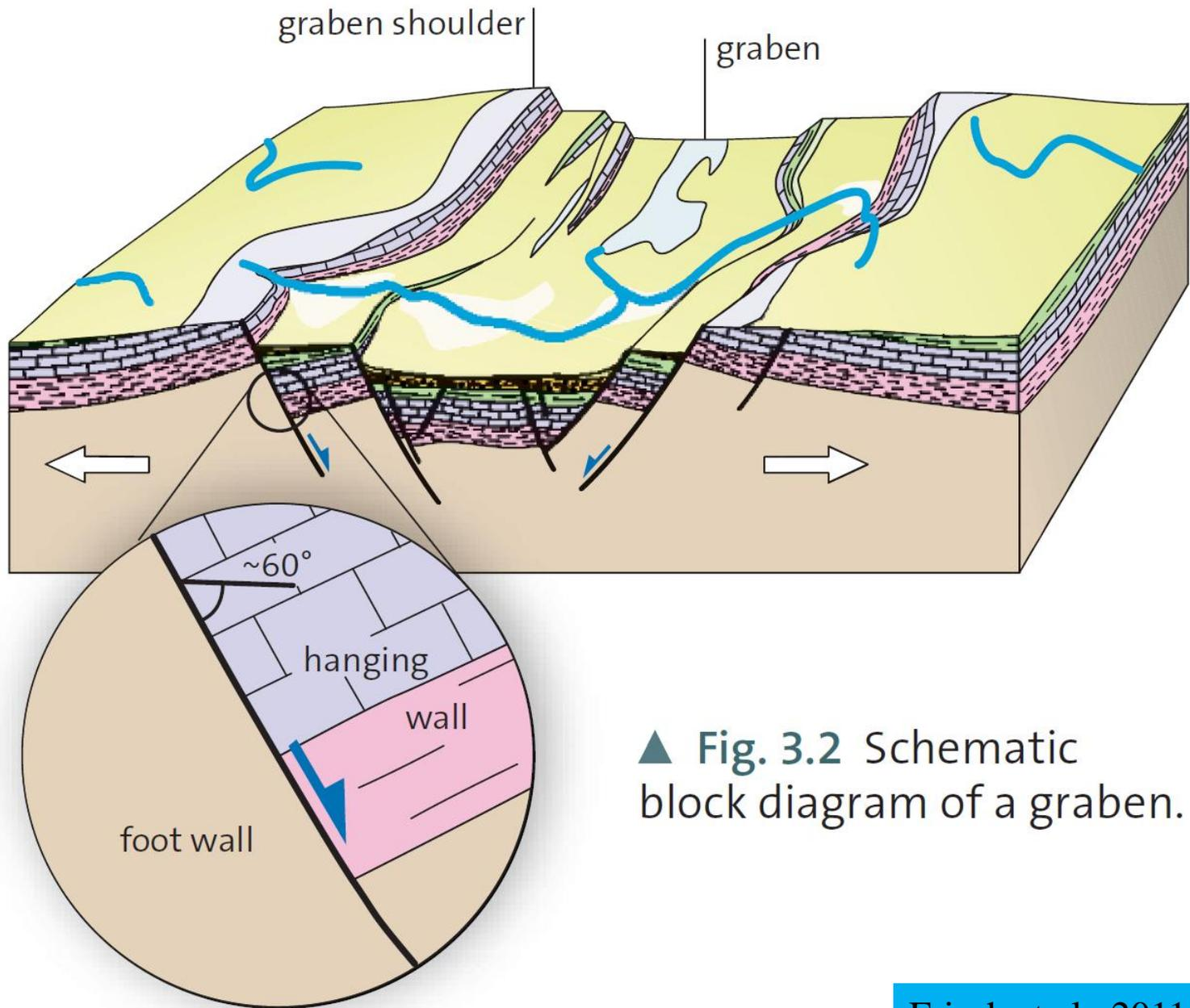
▲ Fig. 3.2 Schematic block diagram of a graben.
